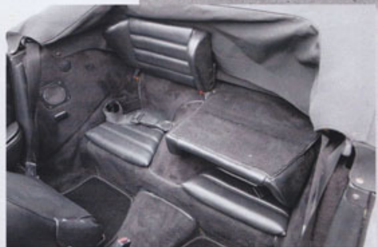
Il est conseillé de rabaisser les dossiers avant d'ouvrir la capote pour faciliter son repliage
